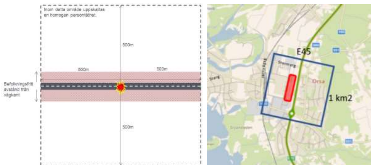
Figur 14. T.v. Principskiss för hur persontätheten har räknats fram. Personerna inom hela området antas befinna sig jämt utspridda över ytan. En befolkningsfri yta ansåts utmed vägen. T.h. studerad yta om 1 km 2 i Orsa med E45 och planområdet i centrum.
