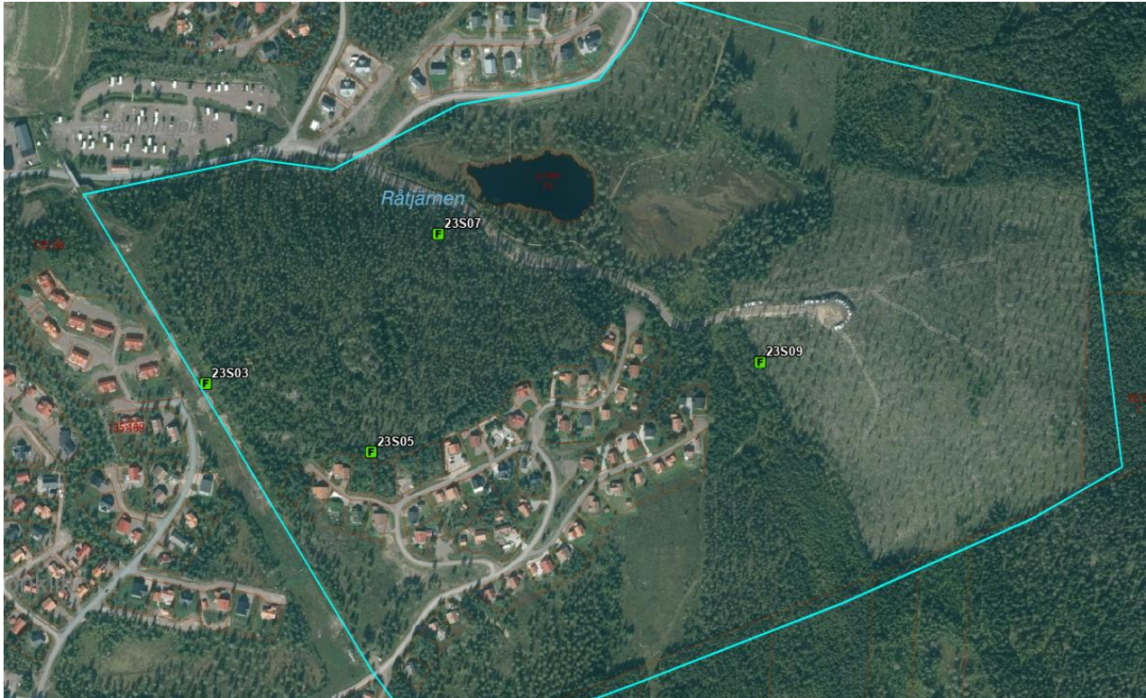
Figur 5. Placering av installerade grundvattenrör.
